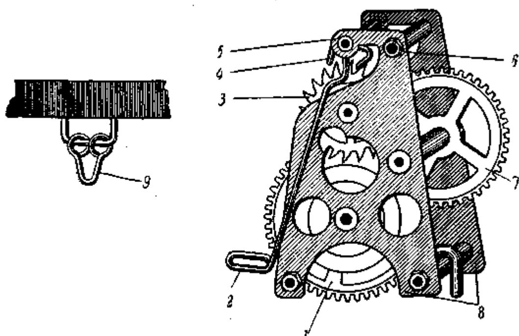
Рис. 209. Механизм ходиков (вид с задней стороны):
