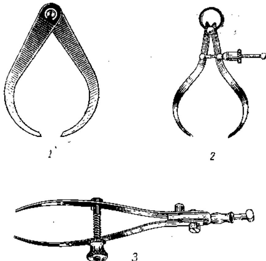
Рис. 54. Три типа кронциркуля: 1 — простой; 2 — пружинный; 3 — эластичный
