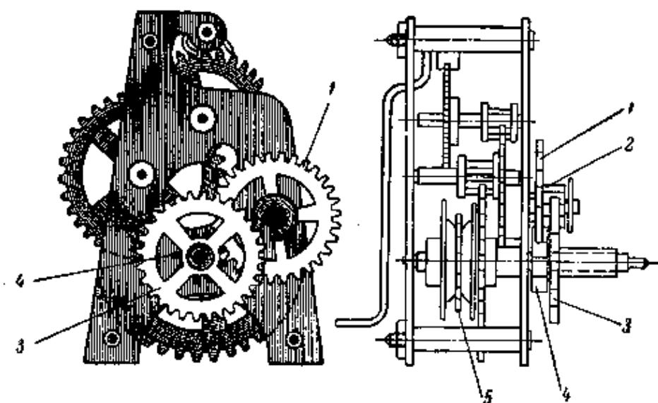
Рис. 210. Механизм ходиков (вид спереди и сбоку):
