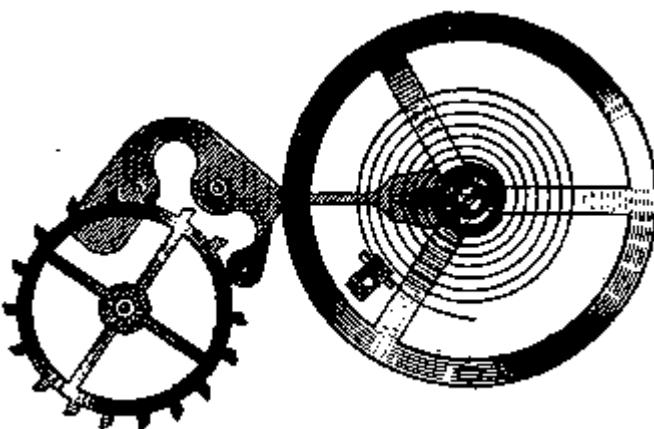
Рис. 170. Узел хода малогабаритного будильника со штифтовым ходом
