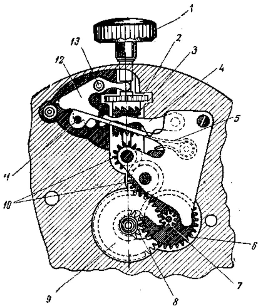
Рис. 30. Схема узла завода и перевода стрелок:
