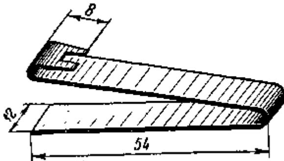
**Рис. 183. Винтодержатель**
