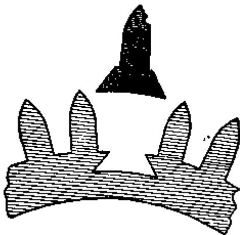
Рис. 115. Вставка зуба в вексельное или часовое колеса
