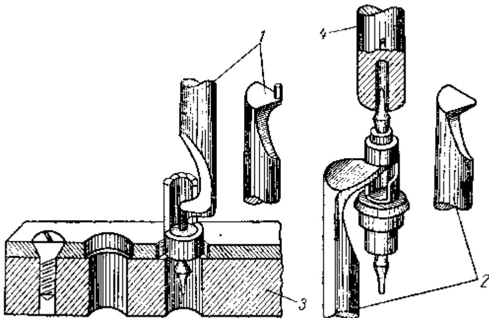
Рис. 165. Специальные пuhanсоны для удаления и вставки пробок:
