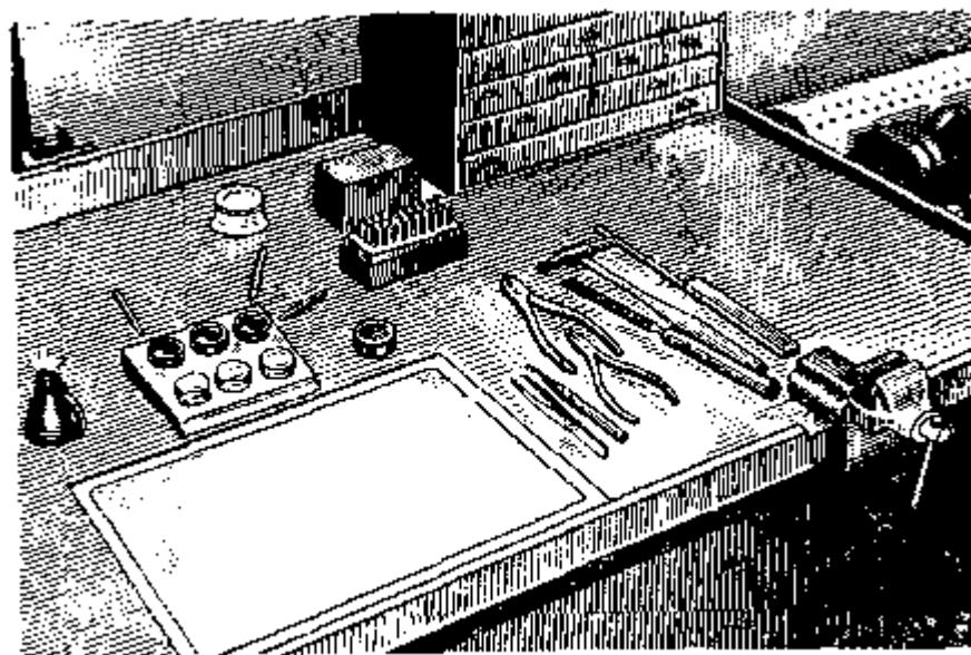
Рис. 42. Порядок размещения инструмента на рабочем месте
