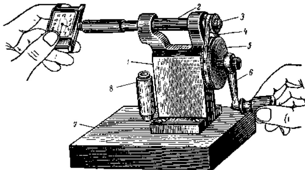
Рис. 219. Приспособление для заводки часов
