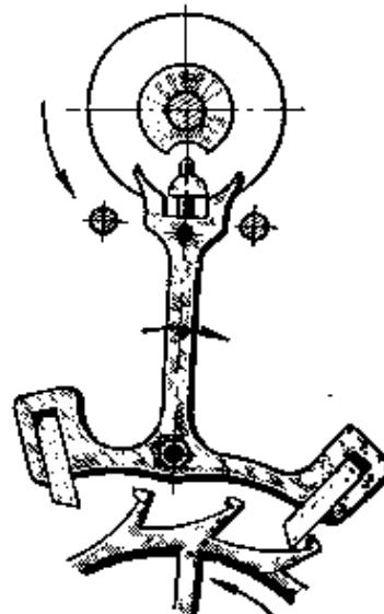
Рис. 120. Заклинивание эллипса при обратном переводе стрелок
