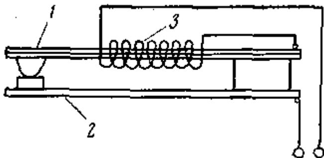
Рис. 186. Термореле:
