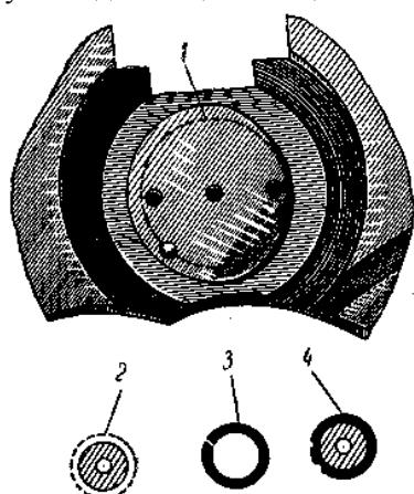
Рис. 135. Исправление уступа на мосту заводного колеса:
