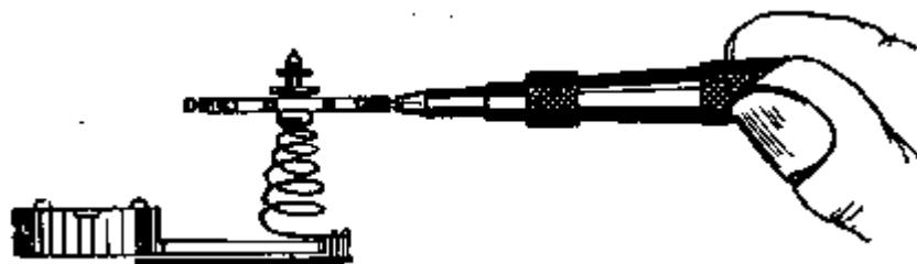
**Рис. 95. Клюбка для завинчивания и отвинчивания винтов баланса**
