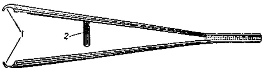
Рис. 58. Пинцет для шлифовки и полировки винтов:
