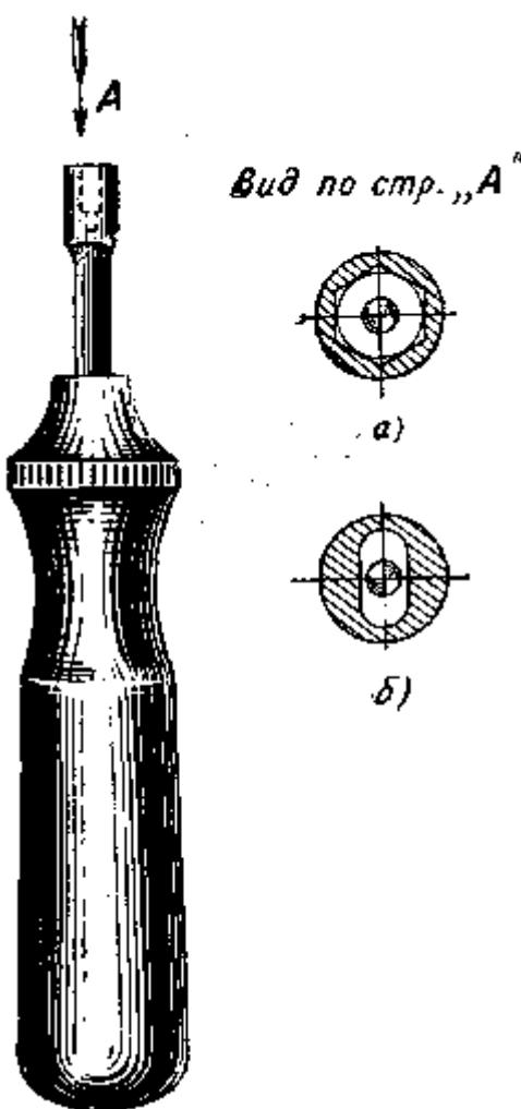
Рис. 178. Ключи для отвертывания гаек и центровых винтов
