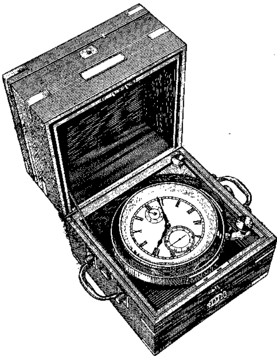
Рис. 216. Эталонный хронометр
