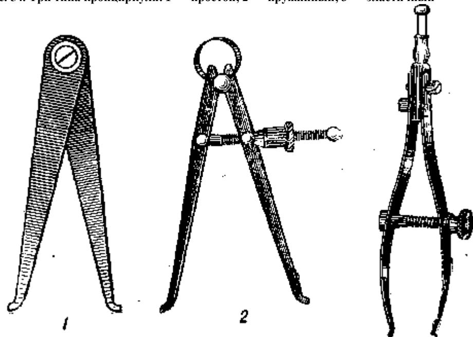
Рис. 55. Три типа нутромера: 1 — простой; 2 — пружинный; 3 — эластичный
