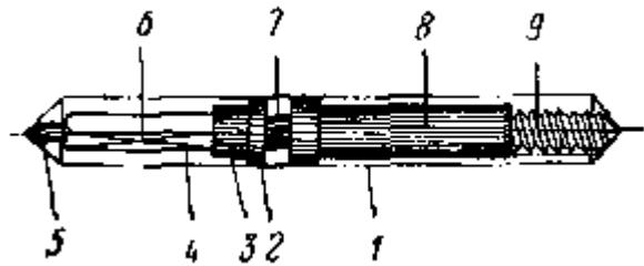
**Рис. 153. Изготовление нового заводного валика:**
