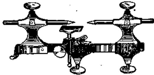
Рис. 45. Токарный станок со смычком и роликом
