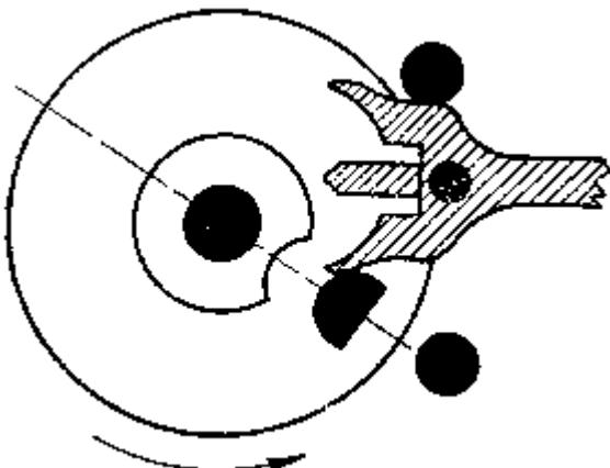
Рис. 118. Заскок эллипса за рожок вилки и проскачивание вилки в противоположную сторону
