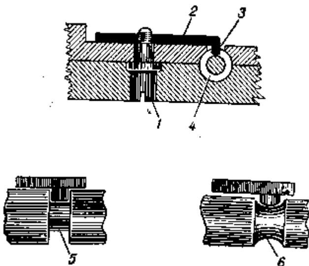
Рис. 151. Винт переводного рычага и переводной рычаг:
