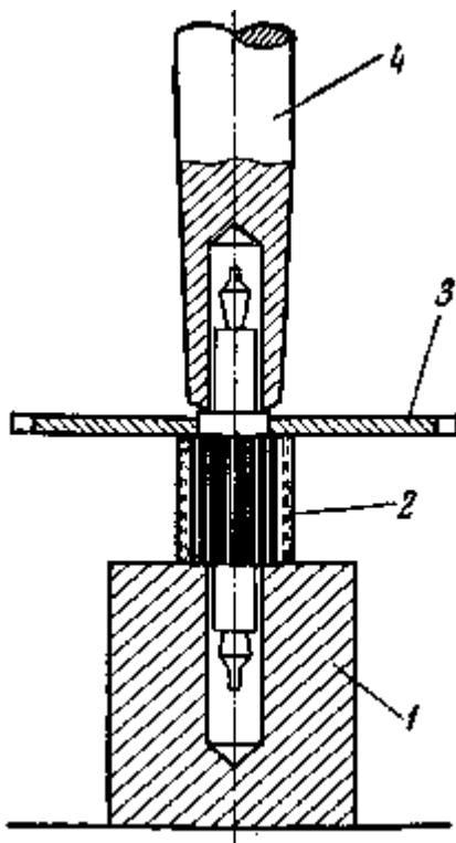
Рис. 128. Закрепление колеса на трибе:
