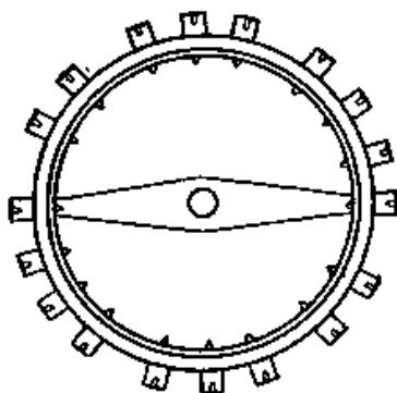
Рис. 6. Монометаллический баланс
