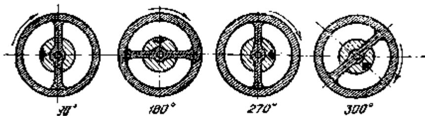
Рис. 24. Последовательные углы отклонения баланса от положения равновесия
