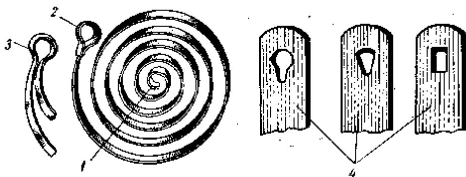
Рис. 173. Формы наружного и внутреннего конца пружины:
