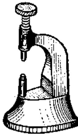
Рис. 162. Ручной пресс для насадки минутной стрелки
