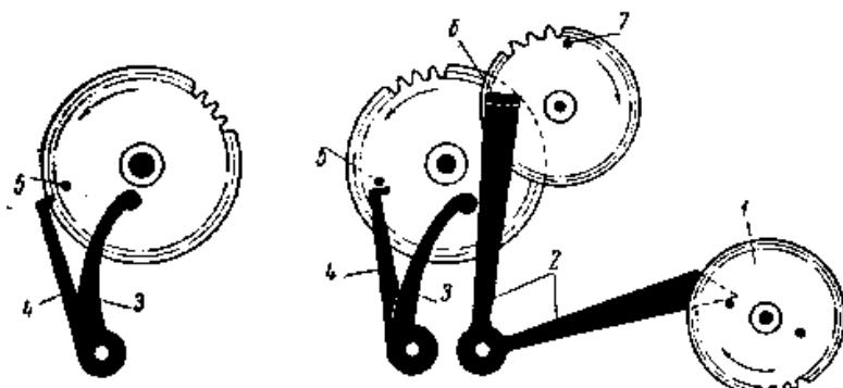
Рис. 197. Схема механизма боя в начале подъема двуплечего рычага отпирания и момент подъема рычага замыкания:
