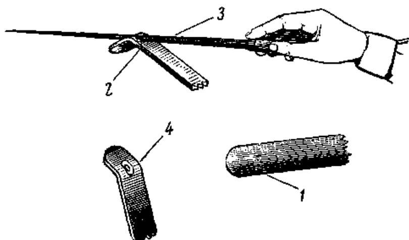
Рис. 147. Пропиловка отверстия во внутреннем конце пружины:
