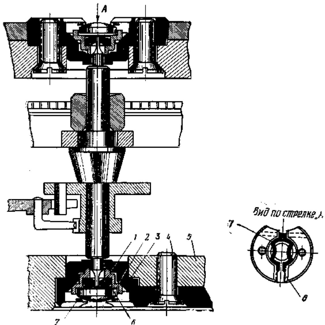
Рис. 34. Узел баланса с амортизатором опор оси баланса
