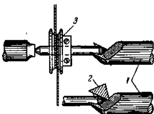
Рис. 181. Заточка оси баланса на токарном станке точильным камнем:
