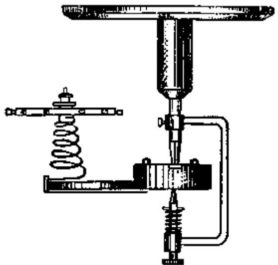
**Рис. 94. Приспособление для подвешивания моста с узлом баланса**
