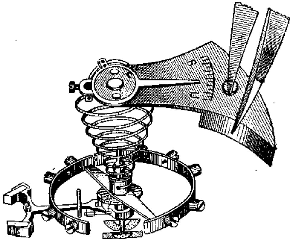
Рис. 160. Правильная установка узла хода в механизм
