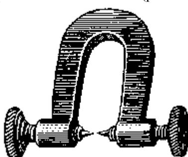
**Рис. 131. Подковка для вывинчивания заломанных винтов**
