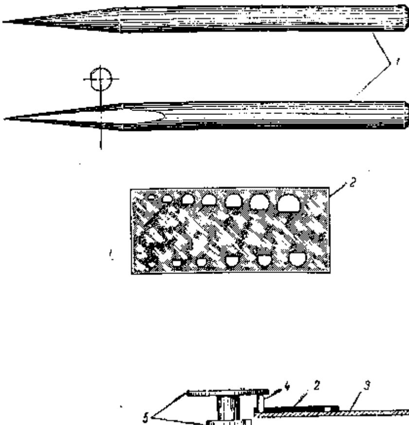
Рис. 109. Приспособление для вставки эллипса в двойной ролик:
