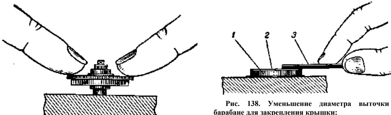
Рис. 137. Способ получения люфта в узле вала барабана
