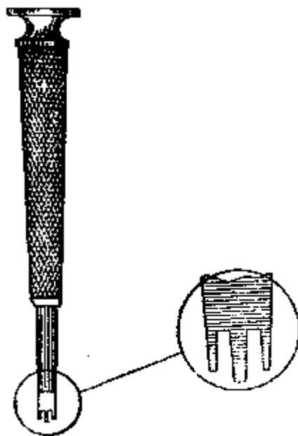
Рис. 177. Фасонная отвертка
