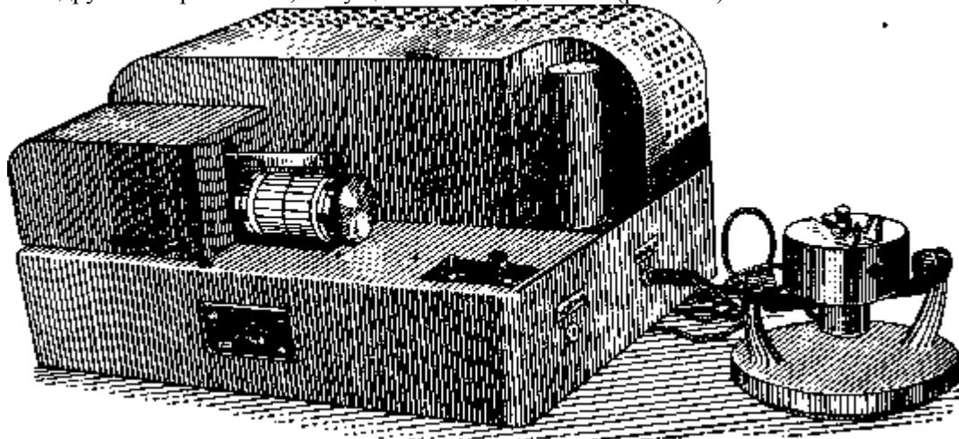
Рис. 217. Прибор для проверки хода часов ППЧ-4
