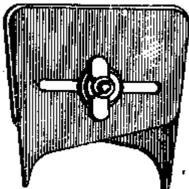
Рис. 68. Универсальный ключ для отвинчивания крышки корпуса
