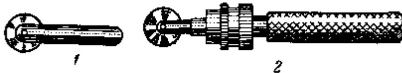
Рис. 134. Зенкер для раззенковки отверстий:
