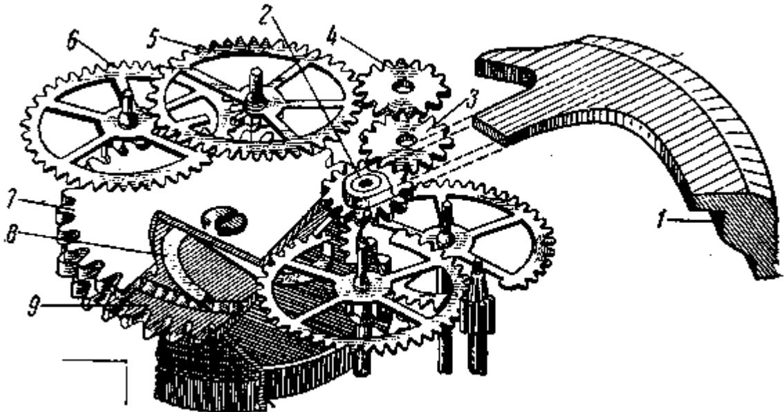
Рис. 37. Кинематическая схема часов с автоматическим заводом
