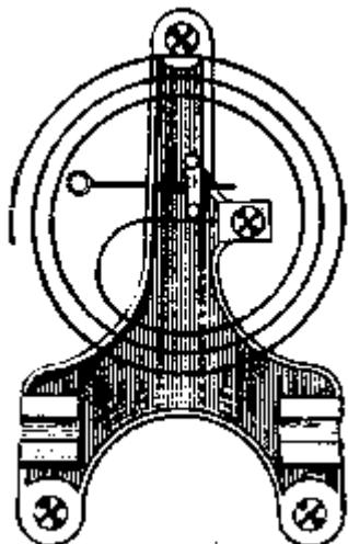
Рис. 207. Низкая установка молотка по отношению к пружине
