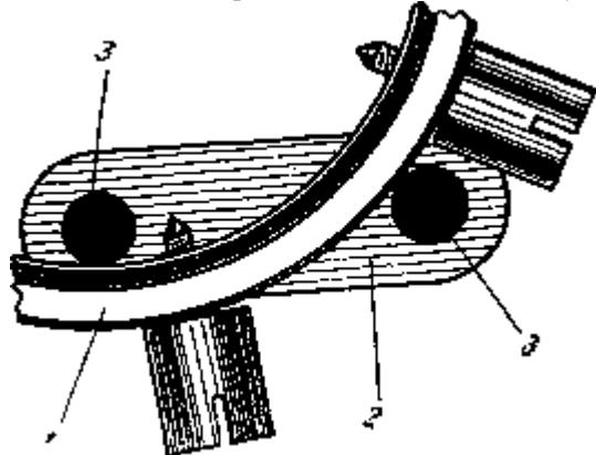
Рис. 90. Выравнивание баланса по радиусу:
