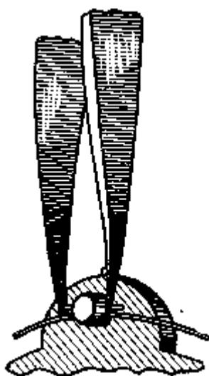
Рис. 73. Закрепление волоска в колонке
