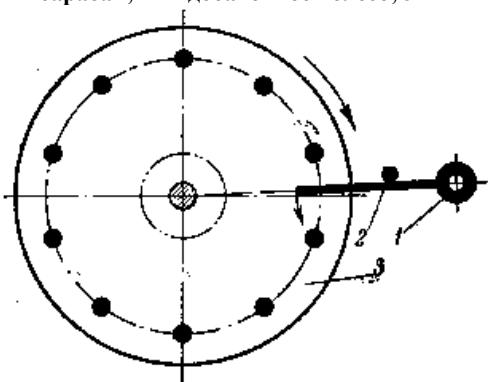
Рис. 196. Колесо с подъемными штифтами и валик молотка:
