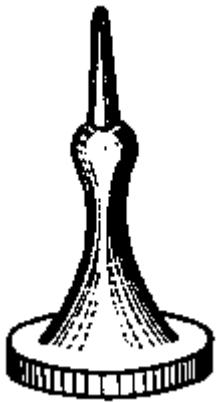
Рис. 161. Специальная наковальня для укрепления минутной стрелки
