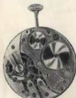
Рис. 2. Механизм 15-каменных карманных часов (вид со стороны мостика)
