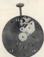
Рис. 3. Механизм карманных 15-каменных часов (вид со стороны циферблата)
