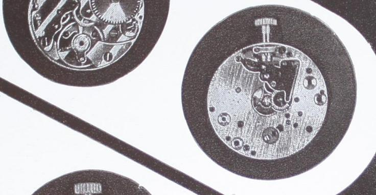
Механизм калибра 26 мм, высота 3,91 мм, на 15 рубиновых камнях, с балансовым регулятором, анкерным спуском, боковой секундной стрелкой, I класса точности по ГОСТ 10733—79.
