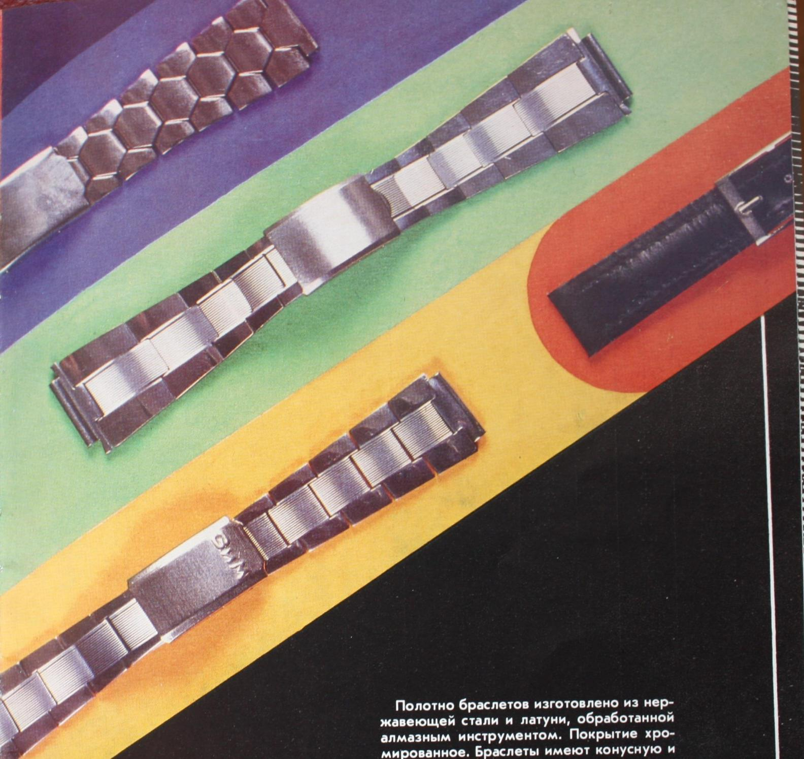
Полотно браслетов изготовлено из нержавеющей стали и латуни, обработанной алмазным инструментом. Покрытие хромированное. Браслеты имеют конусную и ячеичную формы. Неразъемный замок позволяет регулировать длину браслета. Лицевая и боковая поверхности крышки замка, боковая поверхность полотна полированные.
