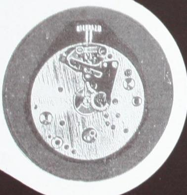
Механизм калибра 26 мм, высота 3,91 мм, на 15 рубиновых камнях, с балансовым регулятором, анкерным спуском, боковой секундной стрелкой, II класса точности по ГОСТ 10733—79.
