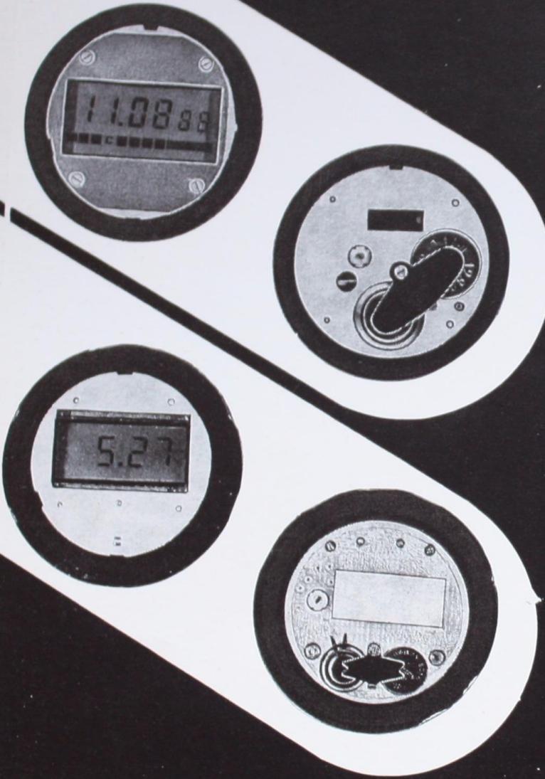
Электронный блок калибра 30 мм, высота 4,5 мм, с кварцевым генератором на интегральной схеме, с цифровым четырехзарядным жидкокристаллическим индикатором на эффекте поля. Индикация часов и минут непрерывна. По вызову — индикация дней недели и числа месяца. Блок имеет подсветку. Цифры индикатора — арабские, семисегментные, черного цвета, высотой 5 мм. Питание от двух батареек типа СЦ-21 или аналогичных. Блок выпускается по 11 МО.081.074 ТУ.
