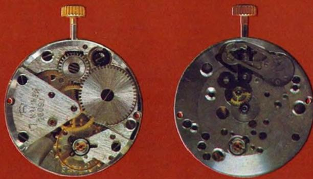
**Das Uhrwerk 2609.1** — Kaliber 26 mm, Werkhöhe 4,5 mm, 17 Rubinstein, zentraler Sekundenzeiger, Stoßsicherung der Unruhwelle. Schwingungsdauer der Unruh 0,4 s. Gangdauer bei einem Gesamtaufzug der Feder mindestens 36 Std. Genauigkeit in 24 Std. +10...—50 s
