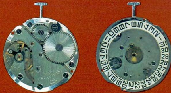
**Mecanismo de relojería 2614, calibre de 26 mm, altura de 4,45 mm, 19 rubies, aguja segundera central, dispositivo antichoque del eje del volante, dispositivo de calendario de acción instantánea que indica las fechas del mes. Volante sin espiral, con periodo de oscilación de 0,4 s. Espiral plana, columna de espiral móvil. Duración de la marcha después de darle cuerda completa no menos de 40 h. El error medio de la marcha del reloj es de 10...—50 s al día**
