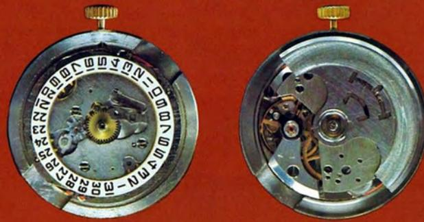
Das Uhrwerk 2627 — Kaliber 26 mm, Werkhöhe 6,55 mm, 29 Rubinstone, zentraler Sekundenzeiger, Stoßsicherung der Unruhwelle, automatischer Aufzug und Doppelkalender, der Datum und Wochentag anzeigt. Schraubenlose Unruh mit Schwingungsdauer 0,4 s. Gangdauer bei vollem Aufzug der Feder gewährleistet mindestens 43 Std. Beim 10stündigen Tragen der Uhr gewährleistet der automatische Aufzug eine Gangdauer ohne Aufziehen von 30 Std. Genaugigkeit in 24 Std.  $\pm 10 \dots -40$  s
