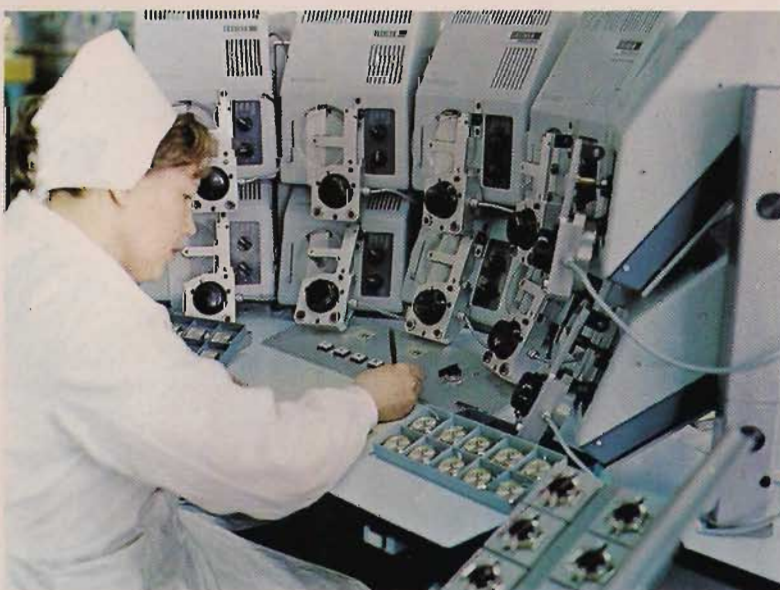
Сложные электронные приборы контролируют точность хода часов
