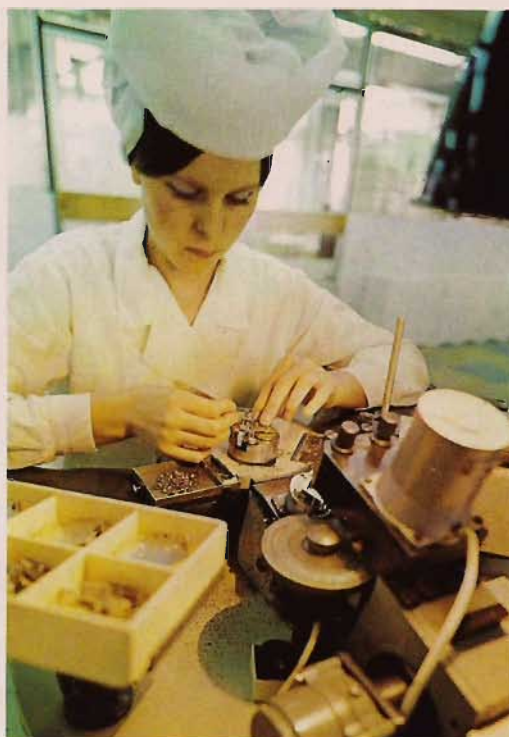
Полуавтоматы собирают узлы часовых деталей
