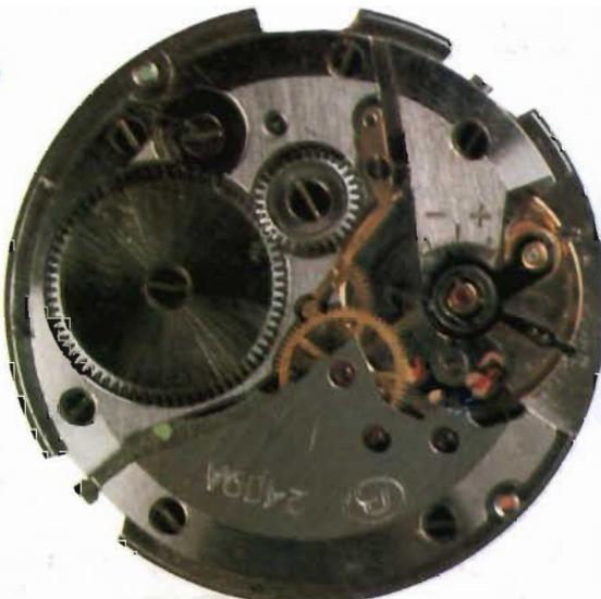
Механизм калибра 24 мм, высотой 3,5 мм, на 17 рубиновых камнях, с противоударным устройством оси баланса, центральной секундной стрелкой.
