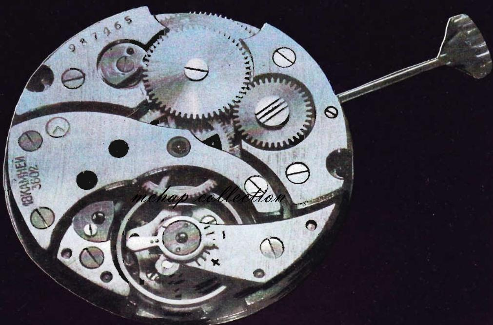
Механизм часов карманных механических 3602, по ГОСТ 10733-79, балансовый, с анкерным палетным спуском, на 18 камнях, с боковой секундной стрелкой, периодичность заводки – один раз в сутки, продолжительность хода от одной полной заводки пружины не менее 39 ч, средний суточный ход от –15 до +40 с. Средний срок службы часов не менее 12 лет.
