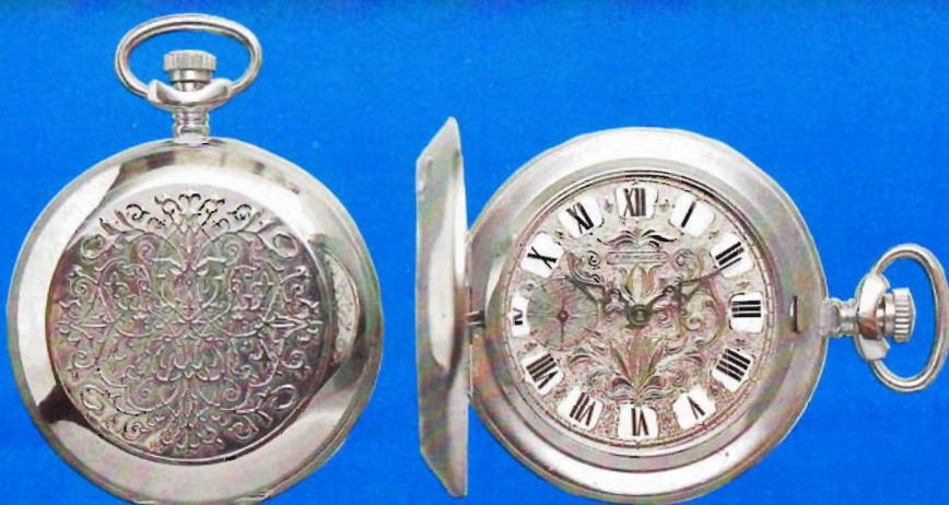
Корпус из нейзильбера, хромированный, полированный. На лицевой поверхности верхней и нижней крышек рельефный рисунок, полученный методом чеканки. Циферблат пластмассовый с рельефным ажурным рисунком в центре. Поле циферблата покрыто лаком различных цветов. Оцифровка арабская. Стрелки плоские.
