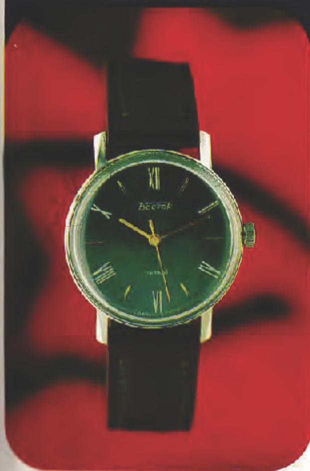
Корпус хромированный, крышка из нержавеющей стали, диаметр корпуса 34,5 мм. Циферблат синий, радиально-штрихованный, шесть знаков часовой шкалы фрезерованные, золотистые, шесть римских цифр и печать белые, стрелки плоские, золоченые.
