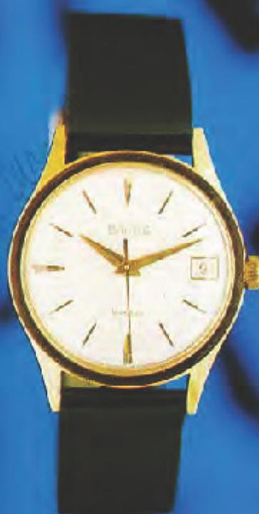
Корпус золоченый, толщина покрытия 10 мкм, крышка из нержавеющей стали, диаметр корпуса 34 мм. Циферблат белый, серебреный, знаки часовой шкалы и рамка календарного окна рельефные, золотистые, печать черная, стрелки золоченые, переменного сечения.
