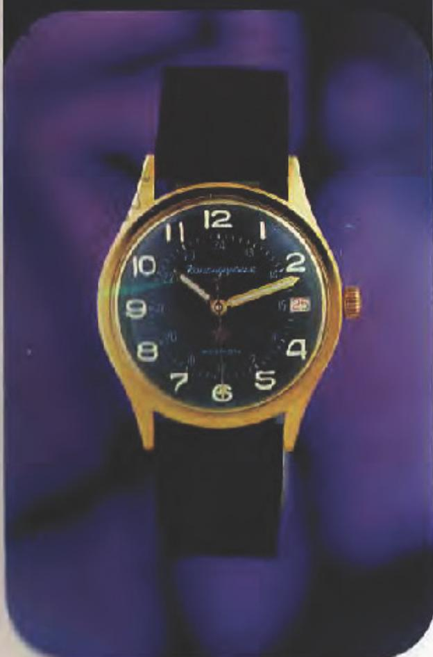
Корпус золоченый, толщина покрытия 20 мкм, крышка корпуса из нержавеющей стали с резьбовым кольцом, диаметр корпуса 34 мм. Циферблат черный, арабские цифры и пятиминутные деления покрыты светомассой постоянного свечения, печать белая, стрелки плоские, золоченные, с окном, заполненным светомассой постоянного свечения.
