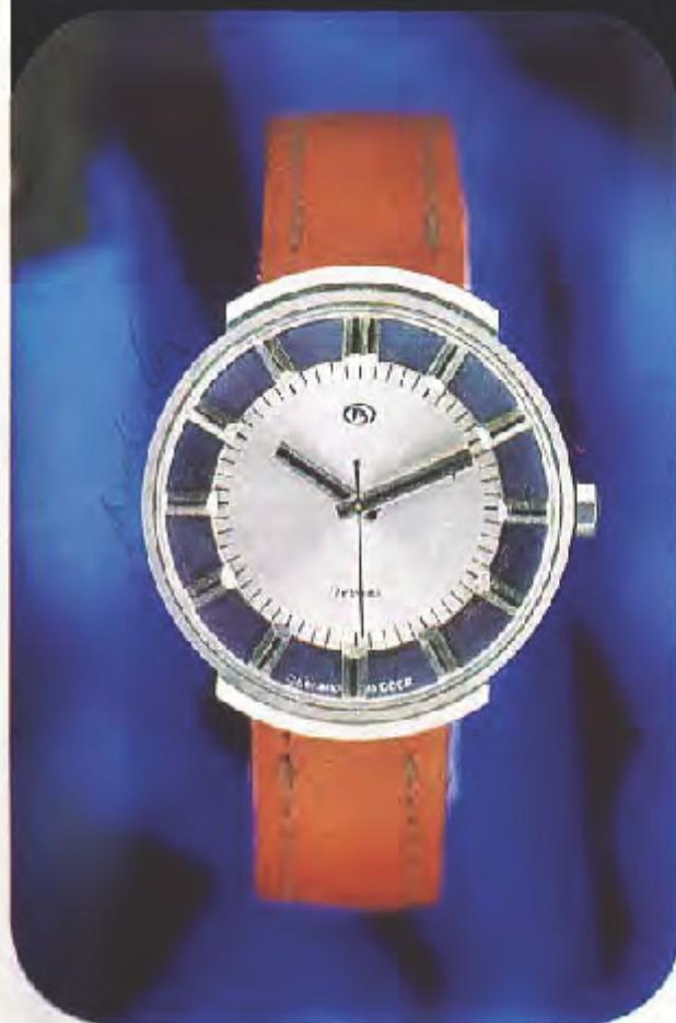
Корпус хромированный, с синим накладным кольцом, крышка корпуса из нержавеющей стали с резьбовым кольцом, диаметр корпуса 38 мм. Циферблат белый, серебреный, знаки часовой шкалы накладные, серебристые, с черными полосками, печать черная, стрелки переменного сечения, никелированные, с черными полосками.
