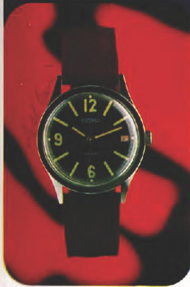
Корпус хромированный или золоченый, толщина покрытия 10 мкм, крышка из нержавеющей стали с резьбовым кольцом, диаметр корпуса 34 мм. Циферблат от серого до темно-серого цвета, арабские часовые цифры и знаки покрыты флюoresцирующей краской, печать белая, стрелки плоские, золоченые или никелированные, с окном, заполненным флюoresцирующей краской.
