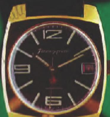
Корпус золоченый, толщина покрытия 20 мкм, крышка из нержавеющей стали с резьбовым кольцом, размер корпуса 40,3 x 33,0 мм. Циферблат вишневый, арабские цифры 6, 9, 12 и знаки покрыты светомассой постоянного свечения, печать белая, стрелки плоские, золоченные, с окном, заполненным светомассой постоянного свечения.
