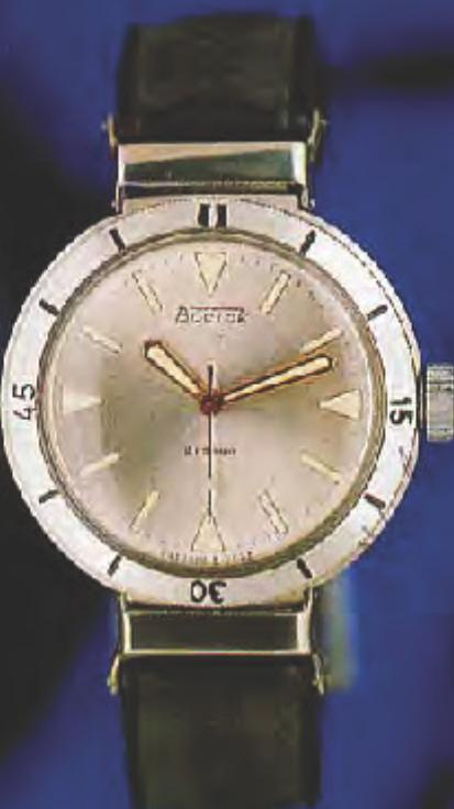
Корпус из нержавеющей стали с браслетом, герметичный, выдерживающий давление до 20 атм, диаметр корпуса 38,2 мм, крышка из нержавеющей стали, с резьбовым кольцом, поворотное кольцо хромированное. Циферблат белый, серебреный, радиально-штрихованный, часовые знаки покрыты светомассой постоянного свечения, минутные деления и надписи — черного цвета, стрелки плоские, вороненые, с окном, заполненным светомассой постоянного свечения.
