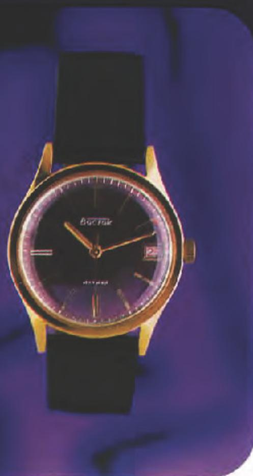
Корпус золоченый, толщина покрытия 10 мкм, крышка из нержавеющей стали с резьбовым кольцом, диаметр корпуса 34 мм. Циферблат темно-вишневый, радиально-штрихованный, знаки часовой шкалы, рамка окна календаря рельефные, золотистые, печать белая, стрелки золоченные, переменного сечения.
