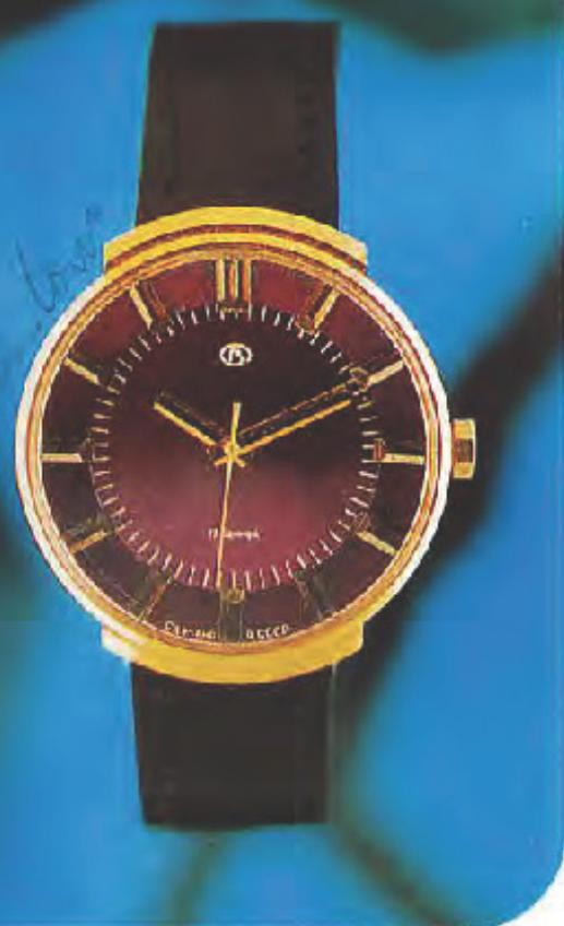
Корпус золоченый, толщина покрытия 10 мкм, корпус с накладным кольцом малинового цвета, крышка корпуса из нержавеющей стали с резьбовым кольцом, диаметр корпуса 38 мм. Циферблат малиновый, радиально-штрихованный, знаки часовой шкалы накладные, золотистые, с черными полосками, печать белая, стрелки переменного сечения, золоченые, с черными полосками.
