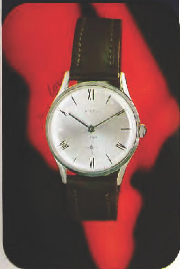
Корпус хромированный, крышка из нержавеющей стали, диаметр корпуса 34,2 мм. Циферблат белый, серебреный, радиально-штрихованный. Знаки часовой шкалы, заменяющие цифры 1, 3, 5, 7, 9 и 11, фрезерованные, серебристые, печать черная, стрелки плоские, никелированные.
