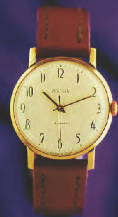
Корпус золоченый, толщина покрытия 12,5 мкм, крышка из нержавеющей стали, диаметр корпуса 34 мм. Циферблат белый, серебреный, радиально-штрихованный, часовые арабские цифры рельефные, золотистые, печать черная, стрелки золоченые, переменного сечения.
