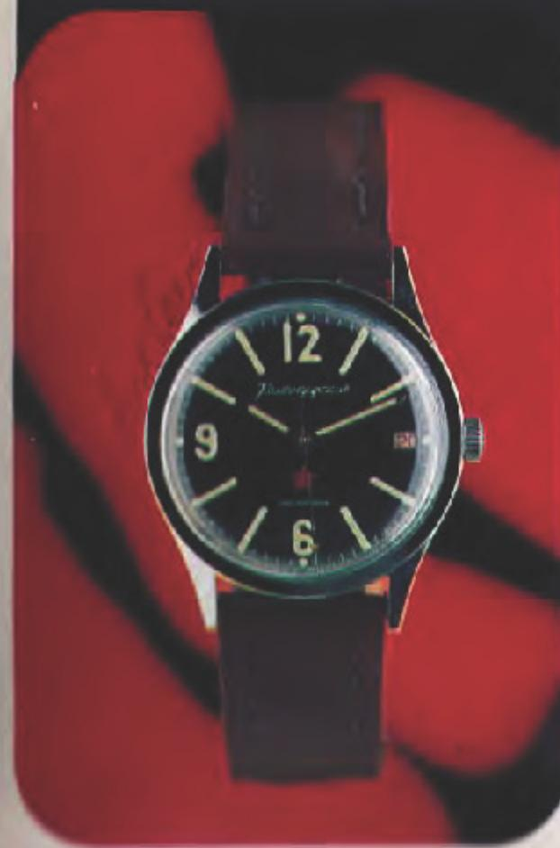
Корпус круглый, хромированный или золоченый, толщина покрытия 20 мкм, крышка корпуса из нержавеющей стали с резьбовым кольцом, диаметр корпуса 34 мм. Циферблат от серого до темно-серого цвета, три цифры, знаки и четыре пятиминутных деления покрыты светомассой постоянного свечения, остальная печать белая, стрелки плоские, золоченые или никелированные, с окном, заполненным светомассой постоянного свечения.
