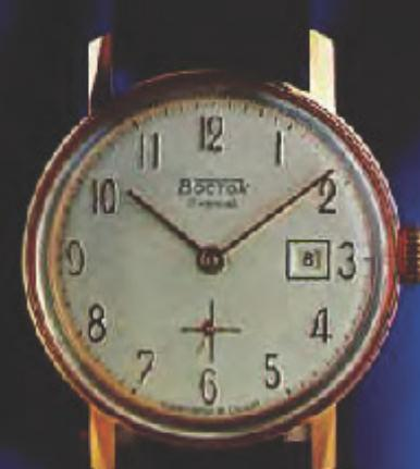
Корпус золоченый, толщина покрытия 12,5 мкм, крышка из нержавеющей стали, диаметр корпуса 34,5 мм. Циферблат белый, серебреный, арабские цифры рельефные, золотистые, печать черная, стрелки плоские, золоченые.
