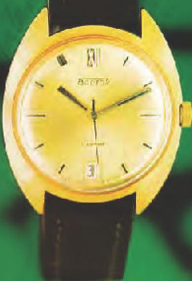
Корпус золоченый, толщина покрытия 20 мкм, крышка из нержавеющей стали, размер корпуса 35,5×41,2 мм. Циферблат радиально-штрихованный, серебреный, с последующим золочением, знаки часовой шкалы, рамка календарного окна рельефные, золотистые, с черными полосками, печать черная, стрелки плоские, золоченые, с окном, заполненным черной краской.
