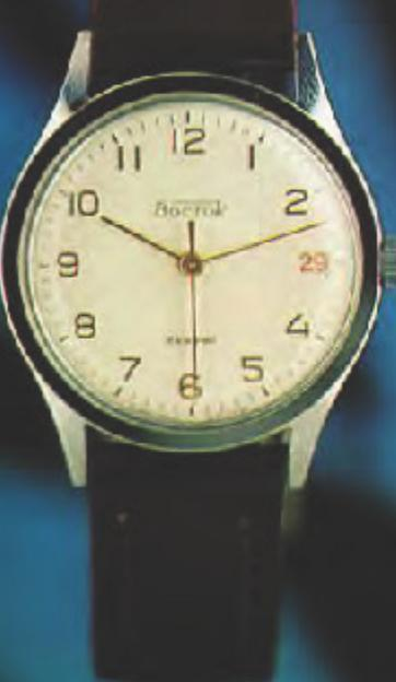
Корпус хромированный или золоченый, толщина покрытия 10 мкм, крышка из нержавеющей стали с резьбовым кольцом, диаметр корпуса 34 мм. Циферблат белый, серебреный, арабские цифры рельефные, золотистые, печать черная, стрелки плоские, золоченые.
