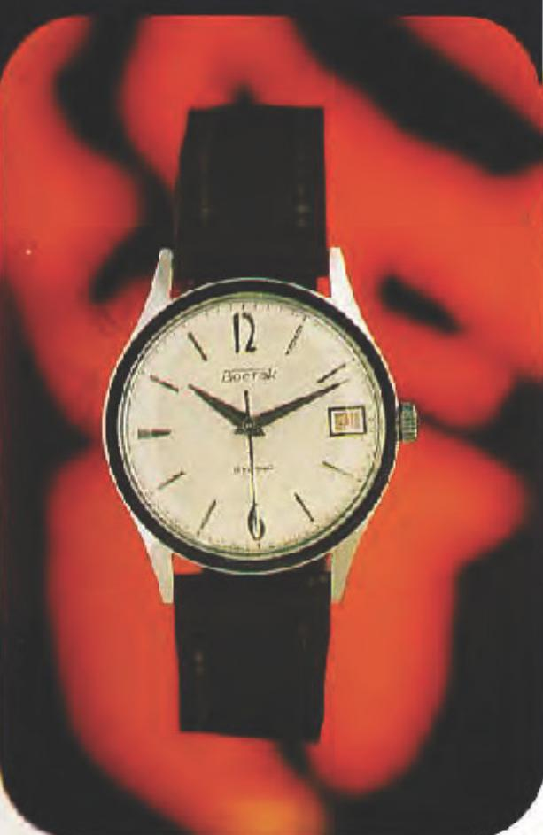
Корпус хромированный, крышка из нержавеющей стали, диаметр корпуса 34 мм. Циферблат белый, серебреный, знаки и цифры часовой шкалы, рамка календарного окна рельефные, белые, печать черная, стрелки никелированные, переменного сечения.
