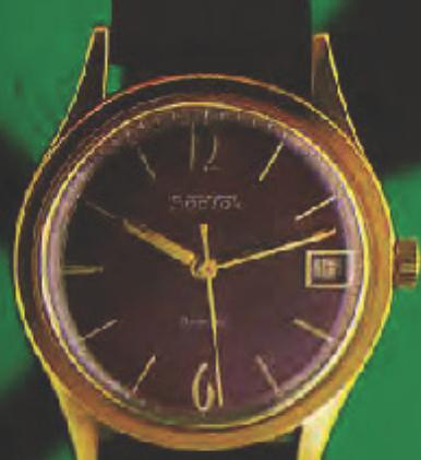
Корпус золоченый, толщина покрытия 10 мкм, крышка из нержавеющей стали с резьбовым кольцом, диаметр корпуса 34 мм. Циферблат темно-вишневый, радиально-штрихованный, знаки часовой шкалы, рамка окна календаря и цифры 12, 6 рельефные, золотистые, печать белая, стрелки золоченые, переменного сечения.
