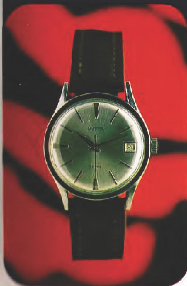
Корпус хромированный, крышка из нержавеющей стали, диаметр корпуса 34 мм. Циферблат белый, серебреный, радиально-штрихованный, знаки часовой шкалы и рамка календарного окна рельефные, серебристые, печать черная, стрелки никелированные, переменного сечения.
