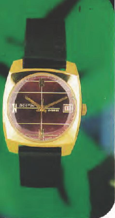
Корпус золоченый, толщина покрытия 10 мкм, крышка из нержавеющей стали, размер корпуса 33,0×40,3 мм. Циферблат вишневый, радиально-штрихованный, знаки, заменяющие цифры 12, 6 и 9, рельефные, золотистые, остальные знаки и печать белые, стрелки золоченные, переменного сечения.
