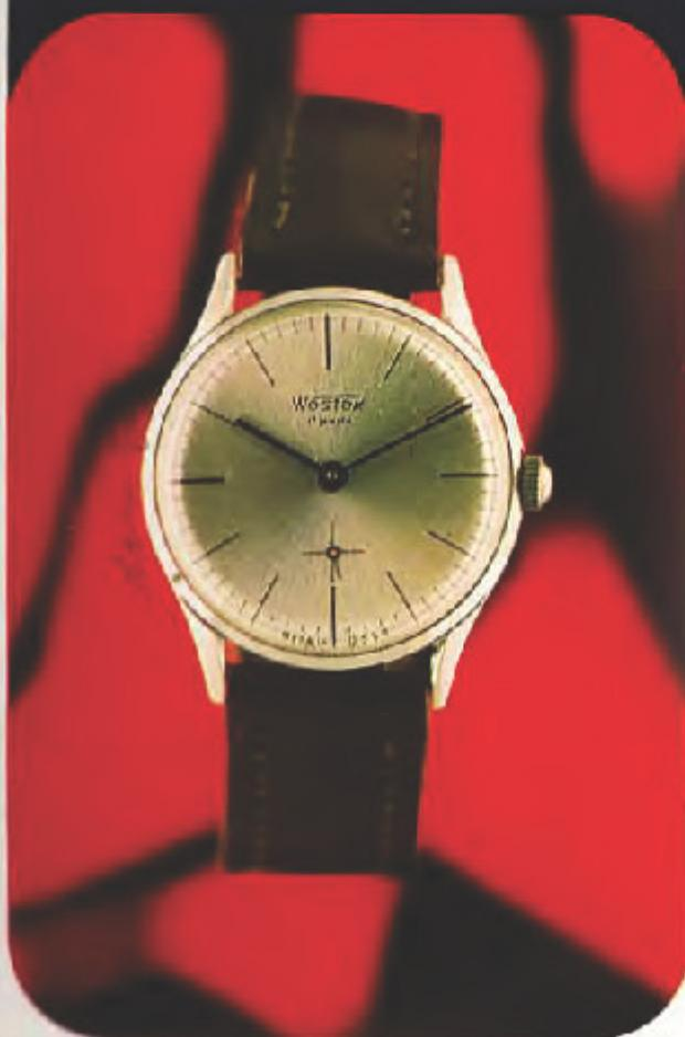
Корпус хромированный, крышка из нержавеющей стали, диаметр корпуса 34,2 мм. Циферблат белый, серебреный, радиально-штрихованный, печать черная, стрелки синевые.
