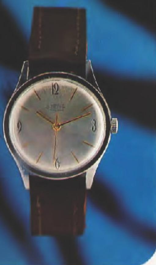
Корпус круглый, хромированный или золоченый, толщина покрытия 10 мкм, крышка из нержавеющей стали с резьбовым кольцом, диаметр корпуса 34 мм. Циферблат белый, серебреный, радиально-штрихованный, знаки часовой шкалы золотистые, печать зерная, стрелки плоские, золоченые.
