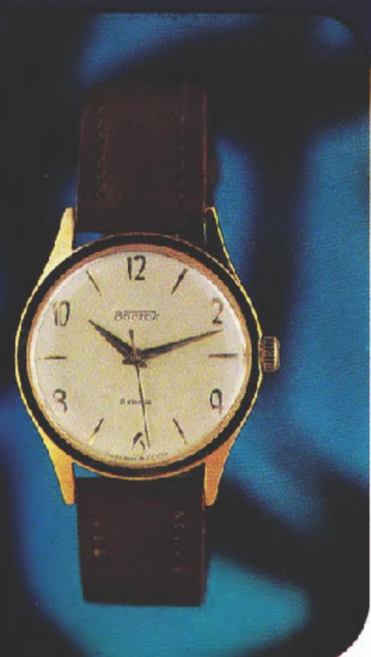
Корпус золоченый, толщина покрытия 10 мкм, крышка из нержавеющей стали, диаметр корпуса 34 мм. Циферблат белый, серебреный, знаки и цифры часовой шкалы рельефные, золотистые, печать черная, стрелки золоченые, переменного сечения.
