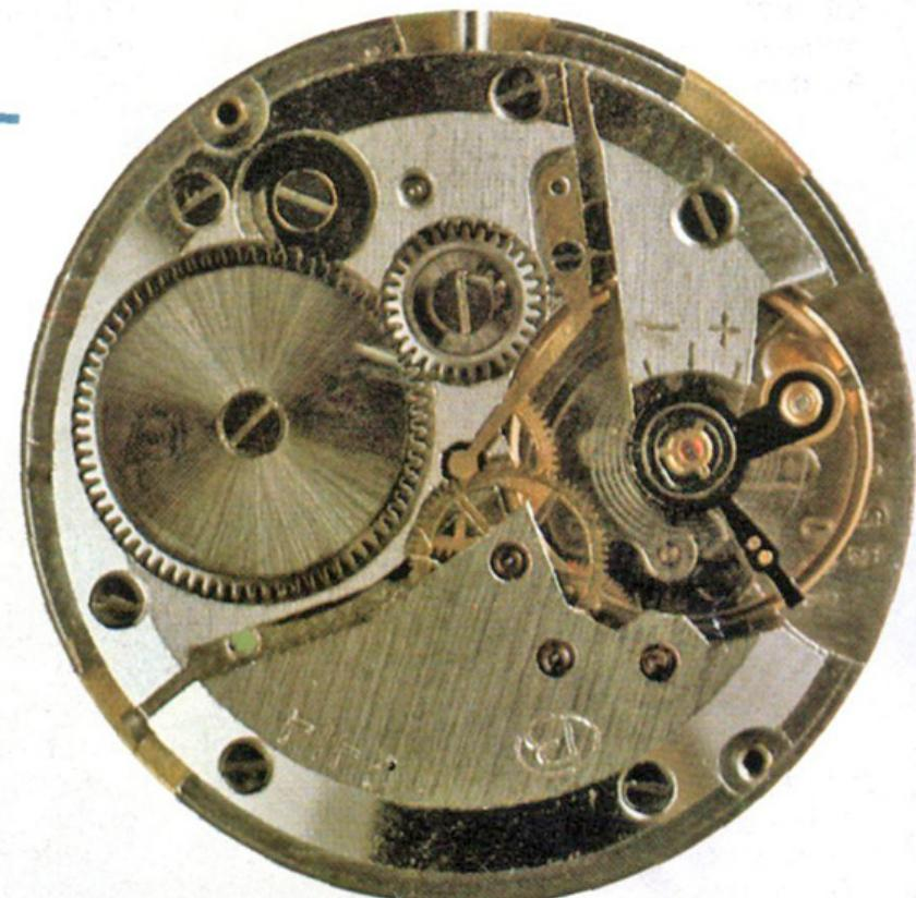
Механизм калибра 24 мм, высотой 3,8 мм, на 17 рубиновых камнях, с противоударным устройством оси баланса, центральной секундной стрелкой, числовым календарем.
