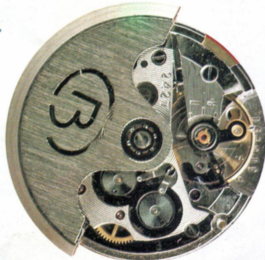
Механизм калибра 24 мм, высотой 5,95 мм, на 21 рубиновом камне, с противоударным устройством оси баланса, с центральной секундной стрелкой, числовым и недельным календарем и автоматическим подзаводом заводной пружины.
