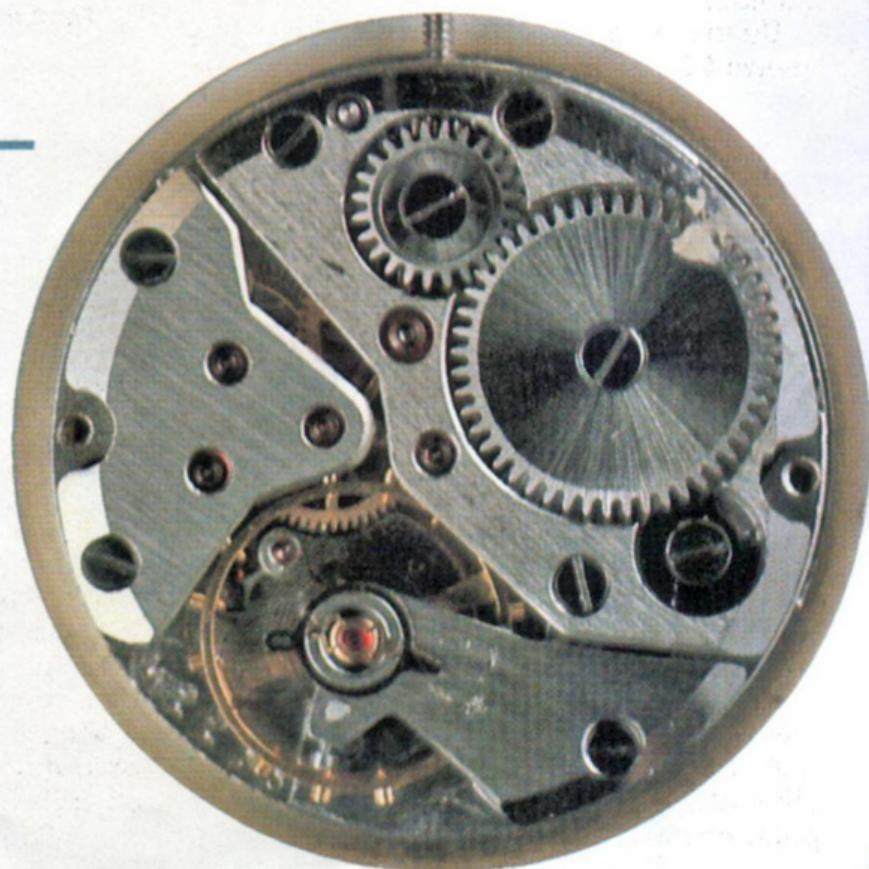
Механизм калибра 22 мм, высотой 3,3 мм, на 18 рубиновых камнях, с противоударным устройством, с центральной секундной стрелкой. Продолжительность хода часов от одной полной заводки пружины не менее 36 ч.
