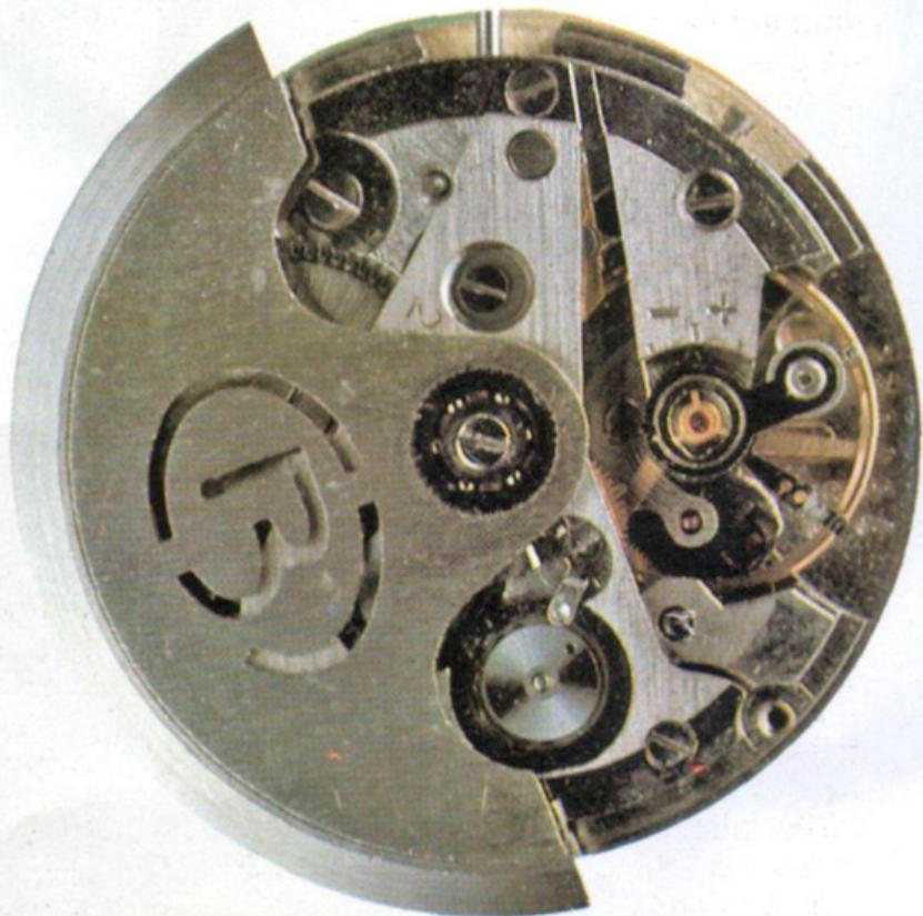
Механизм калибра 24 мм, высотой 5,2 мм, на 21 рубиновом камне, с противоударным устройством оси баланса, с центральной секундной стрелкой, числовым календарем и автоматическим подзаводом заводной пружины.
