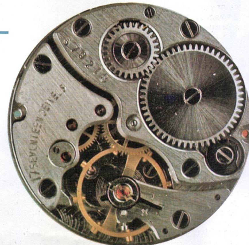
Механизм калибра 26 мм, высотой 4,71 мм, на 17 рубиновых камнях, с противоударным устройством, числовым календарем и боковой секундной стрелкой.
